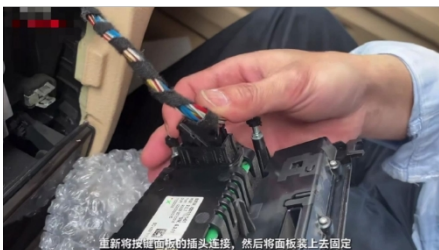
25. Schließen Sie den Stecker des Tastenfelds wieder an und befestigen Sie ihn an seinem Platz
