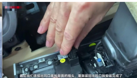
26. Stecken Sie den Stecker hinter der Luftauslassblende ein und bringen Sie den Luftauslass wieder an
