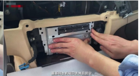
24. Neu installierenden Host und befestigen Sie anbringen
