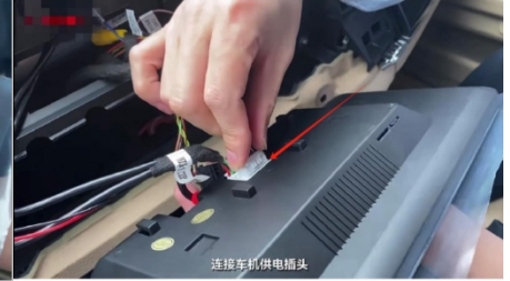
21. Schließen Sie den Netzstecker des Bildschirms an.
