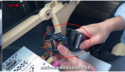
17. Verbinden Sie das weibliche Ende des Netzkabels mit der Original-Stromversorgung des Fahrzeugs
