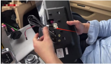
19. Schließen Sie das USB-Kabel an der Rückseite des Bildschirms an
