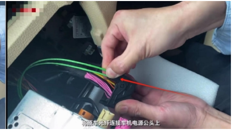
18. Stecken Sie das originale Glasfaserkabel des Fahrzeugs in den Stecker des Netzkabels
