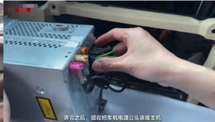
23. Schließen Sie den Netzstecker an den Host an
