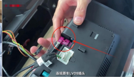
20. Schließen Sie den originalen LVDS-Stecker des Fahrzeugs an
